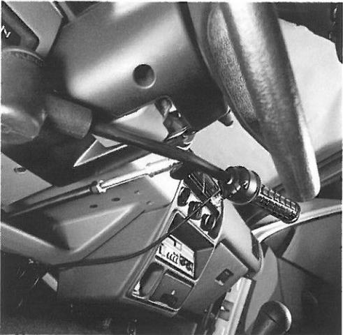
BG-Gerät zum Bremsen und Gasgeben mit der rechten Hand.
