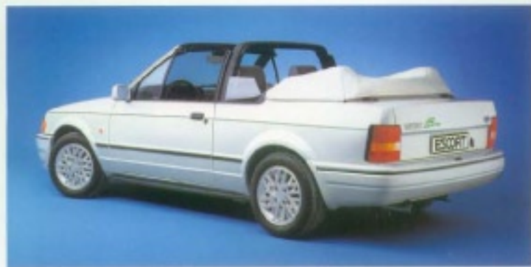
Das Schnellfaltverdeck läßt sich mit wenigen Handgriffen – oder gegen Mehrpreis elektrisch – in kürzester Zeit öffnen und schließen.
